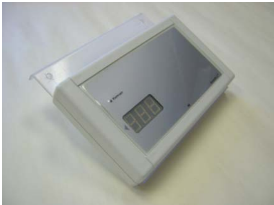
Z-hållare med temperatursensorn fastsatt, nedåtvinklad.
